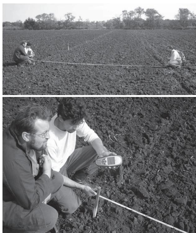
**Obrázok 4** Spôsob merania skutočného pracovného záberu a zapisovanie geografických súradníc monitorovacích bodov
