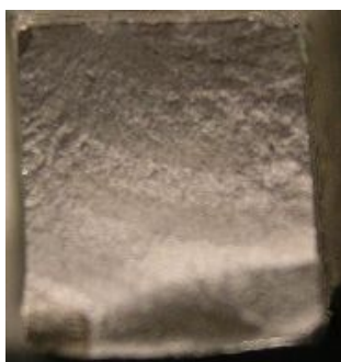
Obr. 1 Křehký lom u damaškové oceli a oceli 14 260
