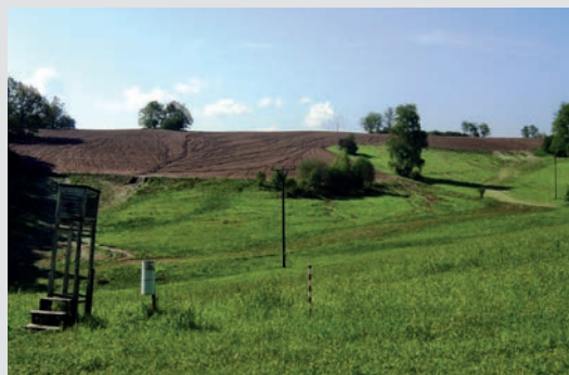
Foto 8: Cesty odtoku povrchové vody z orné půdy přes trvalé travní porosty a srážkoměr na stanici Vadčice. Zdroj: Kvítek T.
