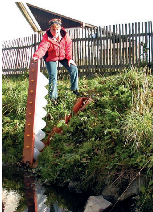
Foto 73: Pravidelná kontrola vzorků vody v pasivním vzorkovači plavenin. Zdroj: Kučera J.
