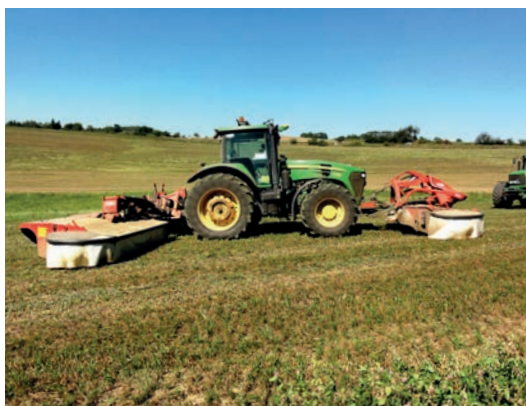
Foto 43: Třídílná disková rotační sekačka píce se záběrem 9 m. Zdroj: Kvítek T.
