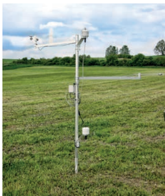
Foto 65: Speciální automatická meteorologická stanice pro měření aktuální evapotranspirace metodou energetické bilance a Bowenova poměru. Zdroj: Duffková R.
