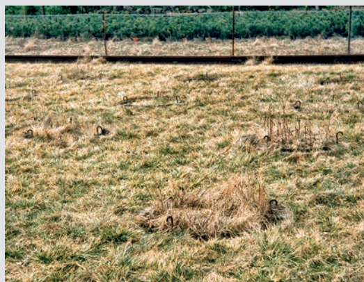
Foto 52: Experimentální lyzimetrická stanice Borkovice s lyzimetry zapuštěnými do úrovně terénu. Zdroj: Kvítek T.
