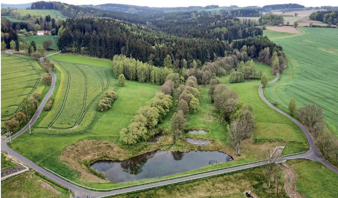
Foto 113: Protipovodňová ochrana intravilánu na vodních tocích s průtočnou malou vodní nádrží plní ochranu jakosti vody za významných srážkoodtokových situací pouze částečně. Zdroj: Páral P.
