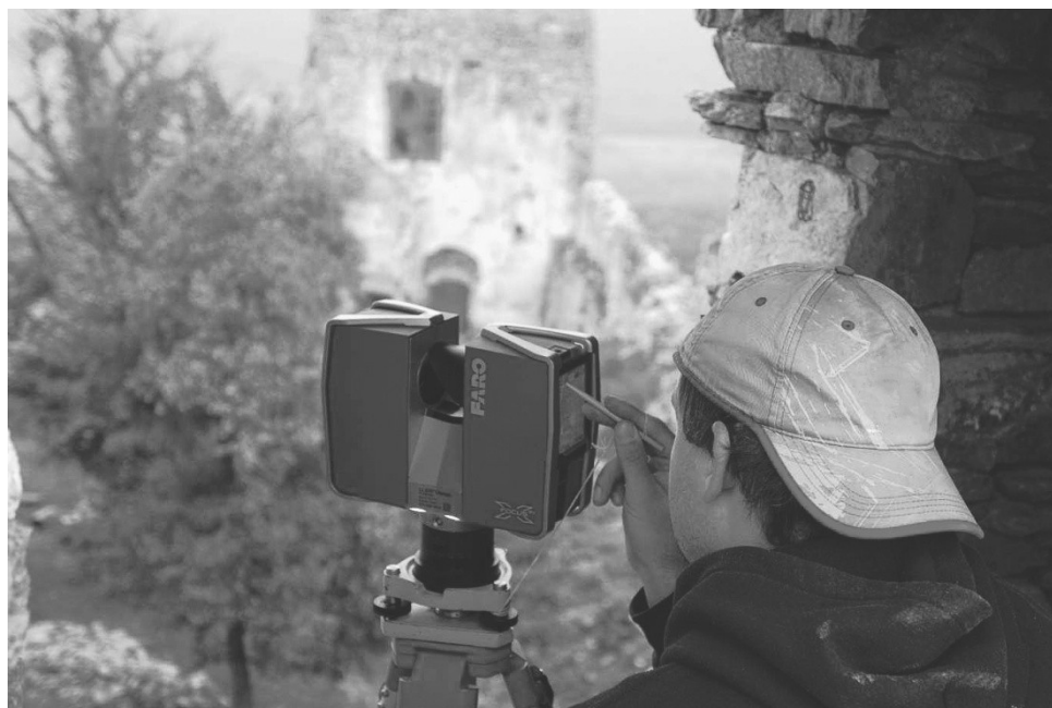
Obr.3: Zber dát v teréne pomocou laserového skenera.
