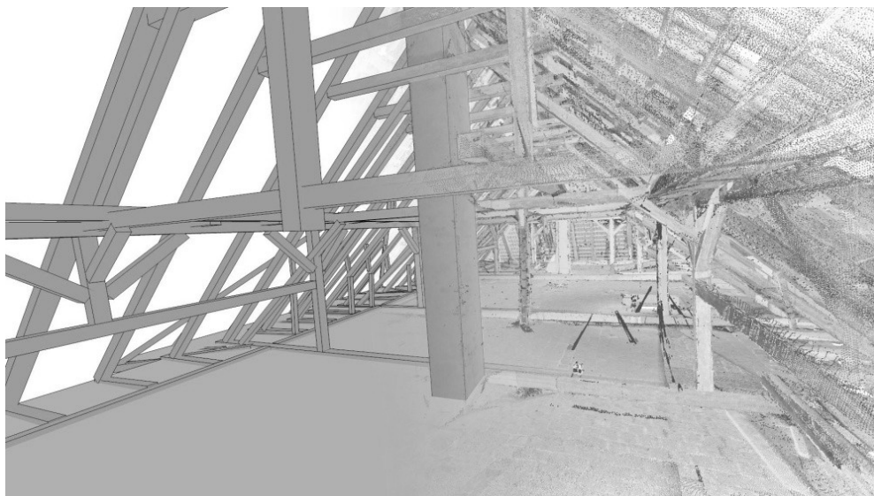
Obr.2: Modelovanie krovu podľa mračna bodov.
