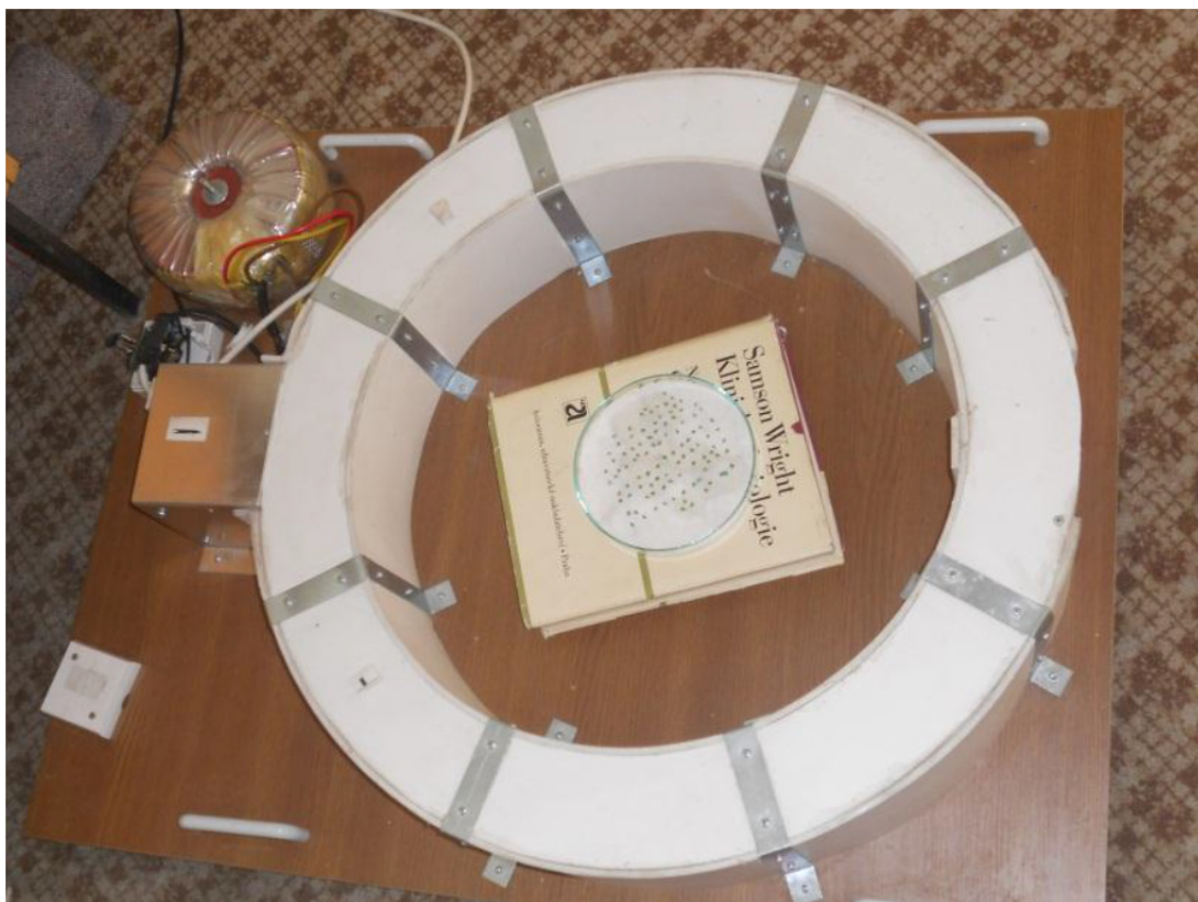
Obrázok 2 Elektromagnetický induktor použitý pri experimentoch s rastlinným materiálom, zostrojený autorským kolektívom pod autorským vedením Jedlička (2016)
