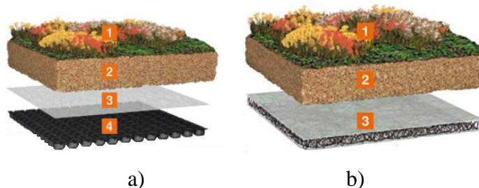
Obr. 1 Systémy Bauder pre extenzívne ozelenených striech v experimente [2] a) DSE 20 (1-rastliny, 2-substrát, 3-filtračná textília, 4-Bauder DSE 20), b) SDF (1- rastliny, 2- substrát, 3- Bauder SDF)
