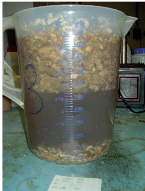
Obrázek 10: Separace mokrou cestou s využitím nádoby s kalibrací na 5 litrů (Foto: F. Jančík)
