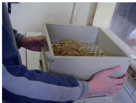
Obrázek 7: Třepací box se síty 19 a 8 mm (Foto: R. Loučka)
