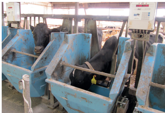
Obrázek 16: Tenzometrické krmné žláby s automatickým zaznamenáváním hmotnosti přijatého krmiva (Foto: R. Loučka)
