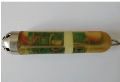
Obrázek 17: Bolus eCOW na měření pH a teploty v bacheru
