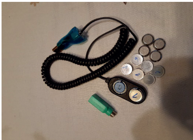
Obrázek 1: Bateriová čidla Thermochron se čtečkou (foto R. Loučka)
