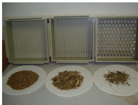
Obrázek 8: Rozložený třepací box, včetně materiálu po protřepání (Foto: R. Loučka)
