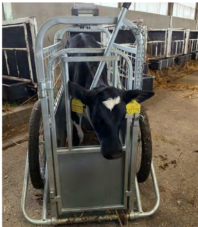
Obrázek 37: Dvoukolák s tenzometrickými vahami, sloužící i k fixaci a převozu telete
