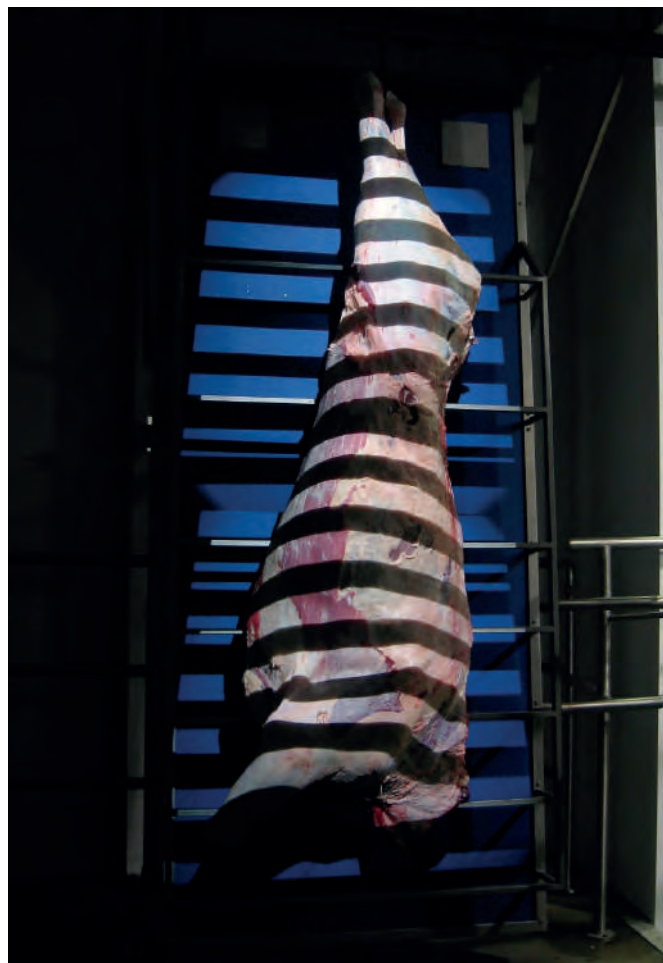
Obrázek 21 Objektivní klasifikace JUT skotu systémem VBS 2000 – 3D snímek
