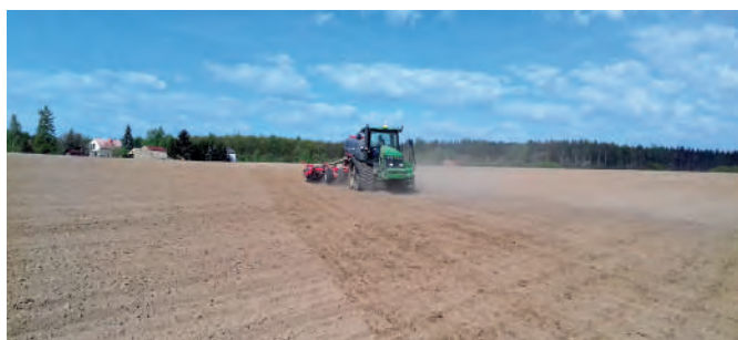
Obr. 37: Setí pásu podle připravené linie, která je přenesena do terminálu traktoru (foto Kroulík).
