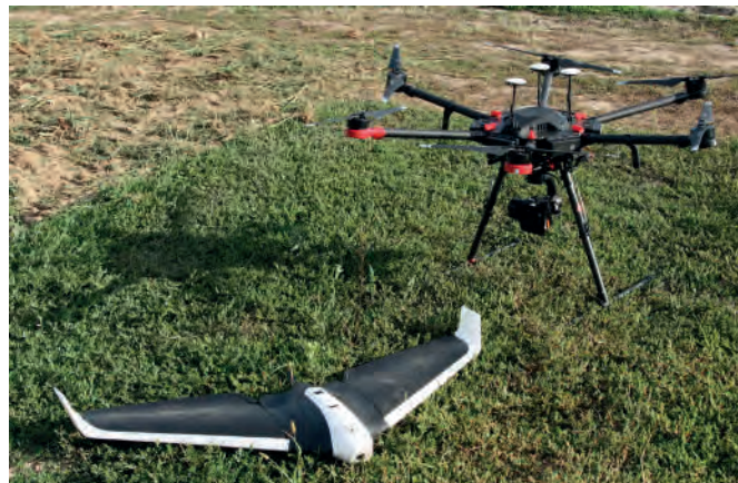
Obr. 74: Konstrukční řešení používaných bezpilotních prostředků, delta křídlo a multikoptéta. (foto Kroulík)
