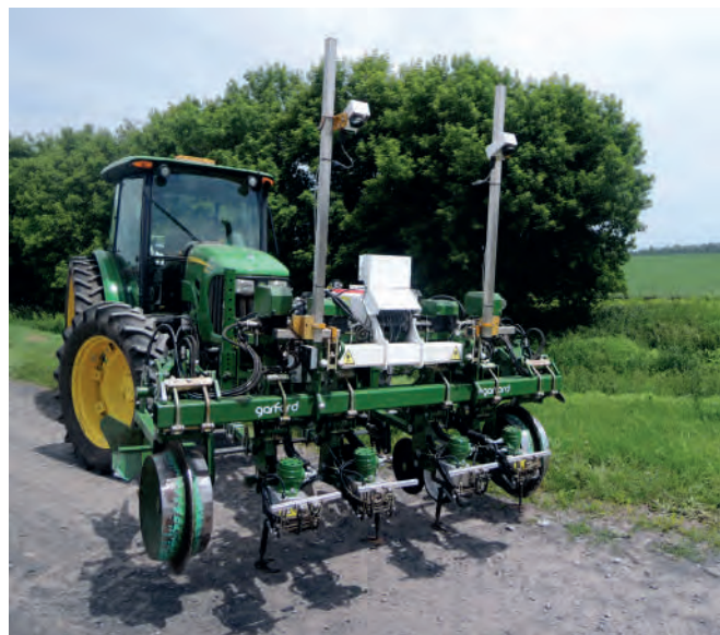
Obr. 64: Poloautonomní kultivar pro mechanickou likvidaci plevelů. (foto Kroulík)
