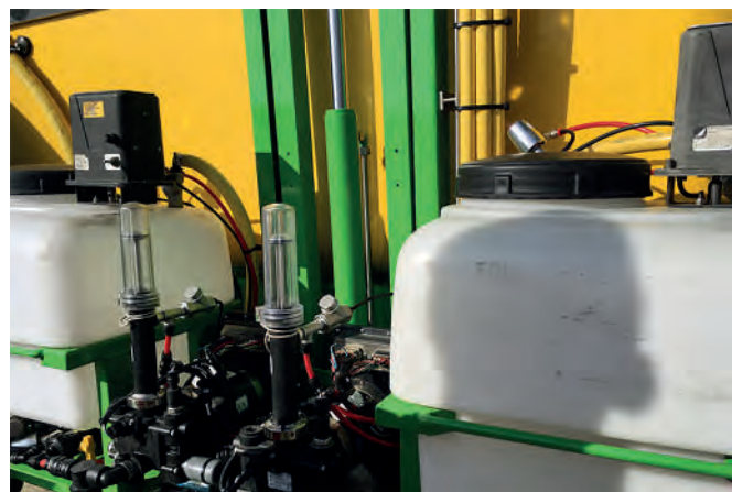
Obr. 62: Detail prototypu postřikovače se 2 nádržemi (bílé) na koncentráty biocidů, směšovací zařízením a cisternou na vodu (žlutě) (foto Jan Lukáš)
