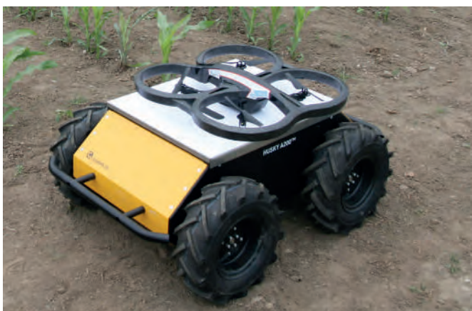
Obr. 75: Kooperace pozemní platformy a bezpilotního prostředku. (foto Kroulík)
