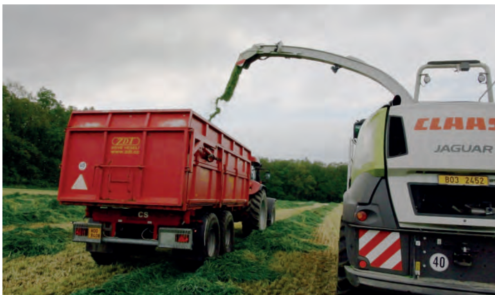
Obr. 6: Sklízecí řezačka Claas se zabudovanou senzorovou technikou. (foto Kroulík).
