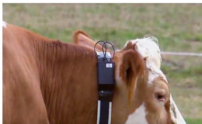
Obrázek 33 – Kráva s nasazeným obojkem se senzory
