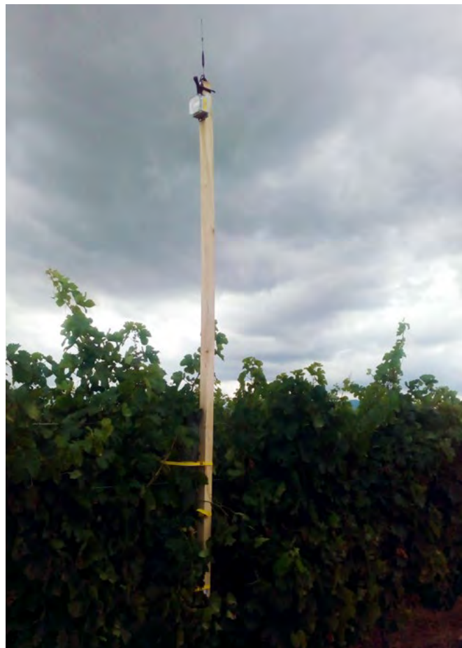
Obrázek 19 – Řídící jednotka pro půdní senzory po montáži uprostřed vinohradu
