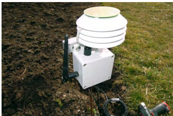
Obrázek 21 – Řídící jednotka pro půdní senzory a vzdušnou teplotu a vlhkost v přízemní výšce
