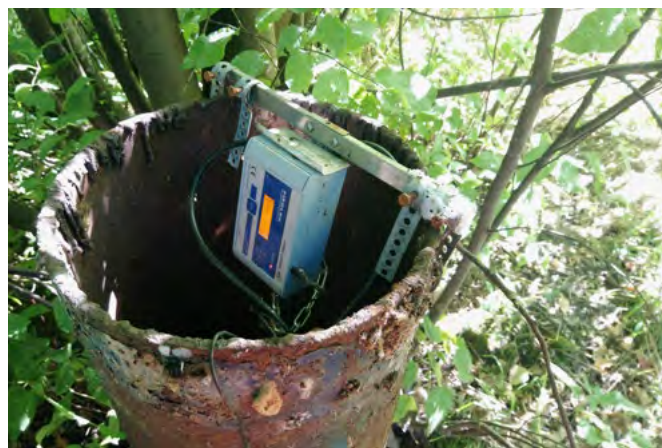
Obrázek 25 – Řídící jednotka pro tlakový senzor hladiny v pažení vrtu
