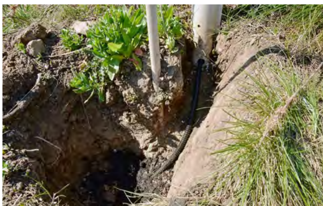
Obrázek 23 – Montáž půdního senzoru do biocharu
