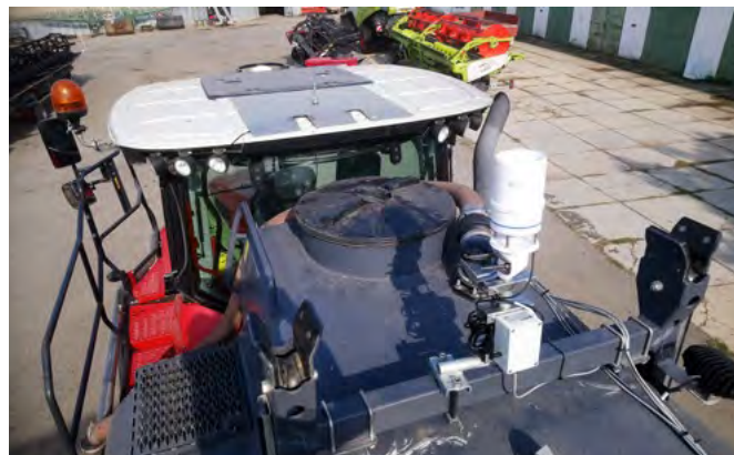
Obrázek 37 – Ukázka montáže meteostanice na postřikovači
