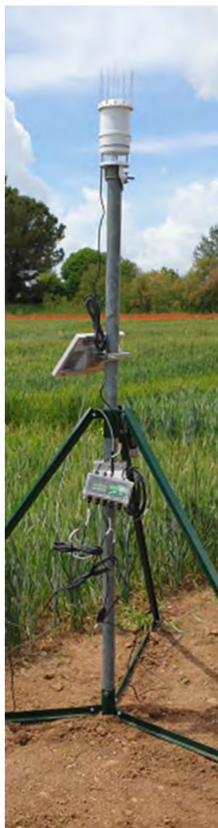
Obrázek 17 – Kompaktní meteostanice s půdními senzory po montáži na poli
