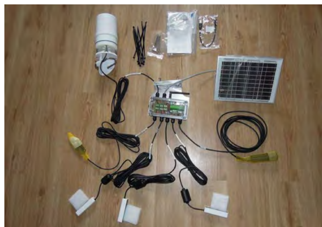
Obrázek 16 – Sestava kompaktní meteostanice s půdními senzory před montáží
