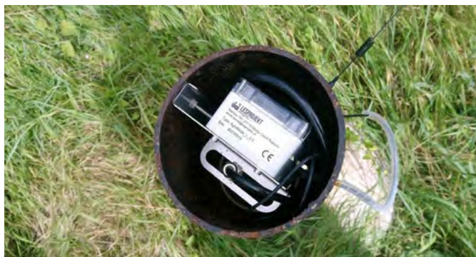
Obrázek 27 – Nová řídicí jednotka pro tlakový senzor hladiny v pažení vrtu
