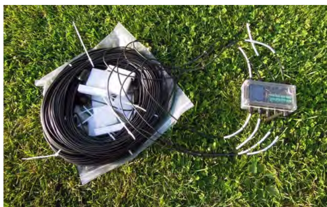
Obrázek 24 – Řídící jednotka pro půdní senzory před montáží
