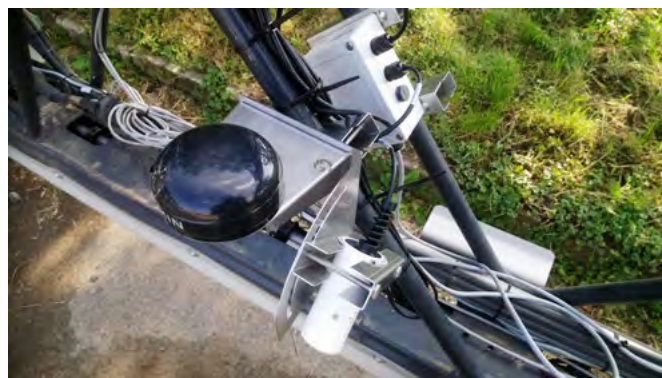
Obrázek 38 – Ukázka montáže řídicí jednotky a GPS antény na postřikovač
