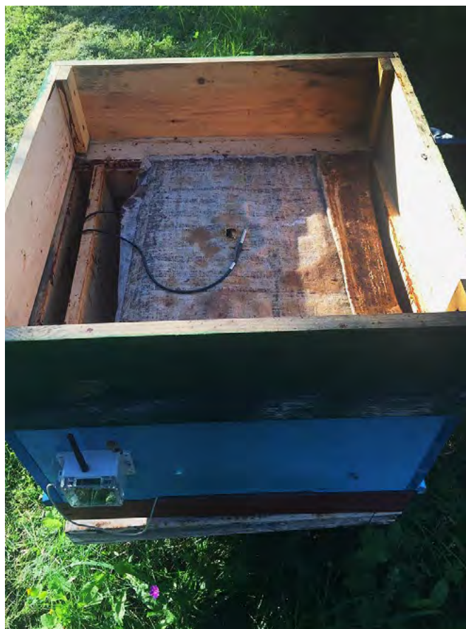
Obrázek 36 – Ukázka rozmístění senzorů uvnitř úlu
