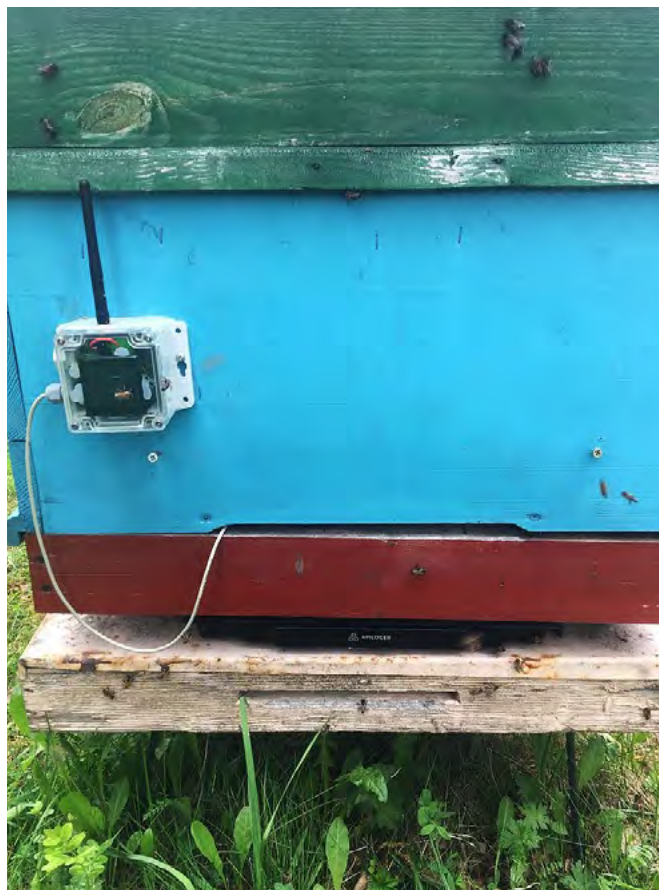
Obrázek 35 – Ukázka montáže řídicí jednotky na úl
