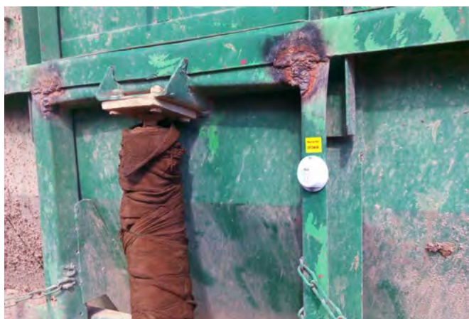
Obrázek 31 – RFID tag na přípojném zařízení
