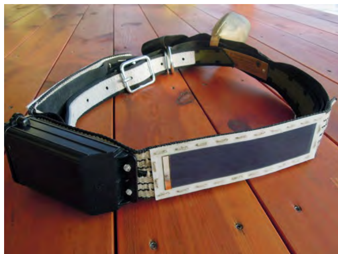
Obrázek 32 – Ukázka kravského obojku s řídicí jednotkou
