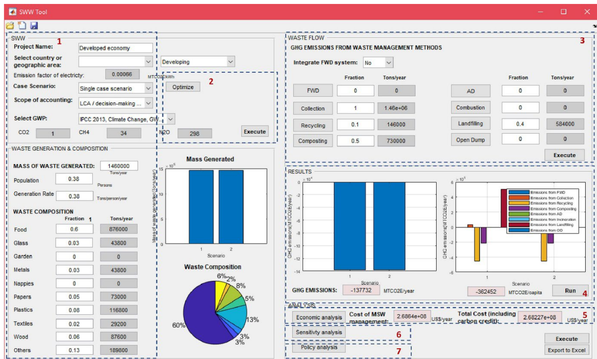
Obr. 14.3. Úvodná obrazovka používateľského rozhrania SWW, 1: Zadávanie údajov; 2: Nástroj na optimalizáciu; 3: Nástroj na účtovanie emisií; 4: Zobrazenie výsledkov; 5: Nástroj ekonomickej analýzy; 6: Nástroj na analýzu citlivosti; 7: Nástroj analýzy politiky (Maalouf & El-Fadel, 2020).
