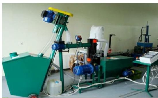
Obrázok 1 Peletovacia linka Kovo Novák MGL 100, vzorky vyrobených peliet
