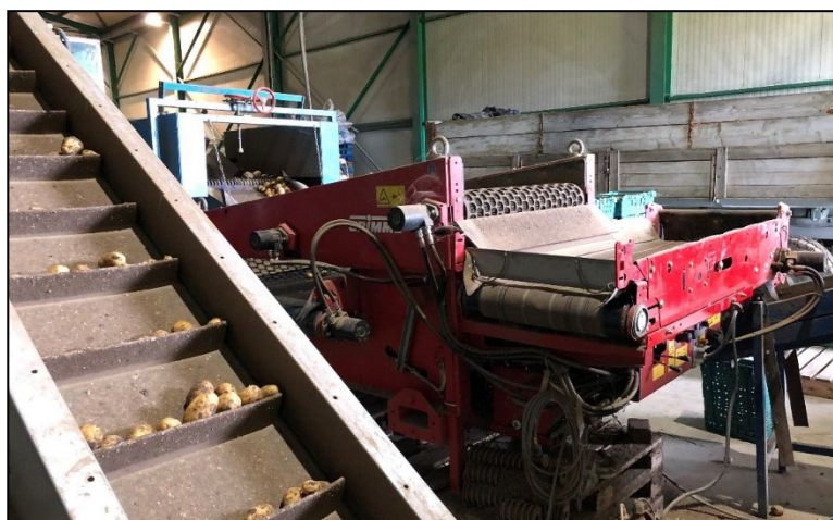
Obrázok 5 Separačné ústrojenstvo Grimme WG 900 (Zdroj: autor)
