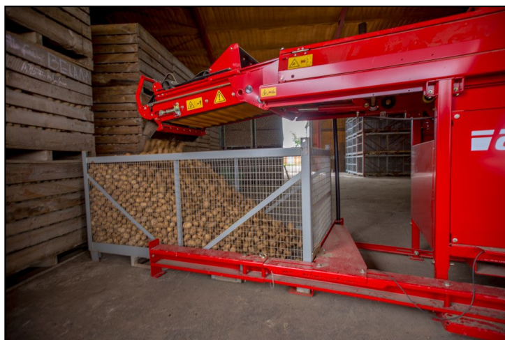
Obrázok 6 Automatický dávkovač paliet a boxov GBF(Zdroj: autor)
