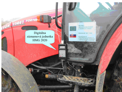
Obr. 2 Umiestnenie záznamového zariadenia HMG 2020 na meracej súprave
