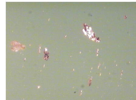
Obr. 14 Častice opotrebenia prítomné vo vzorke po 300 hodinách
