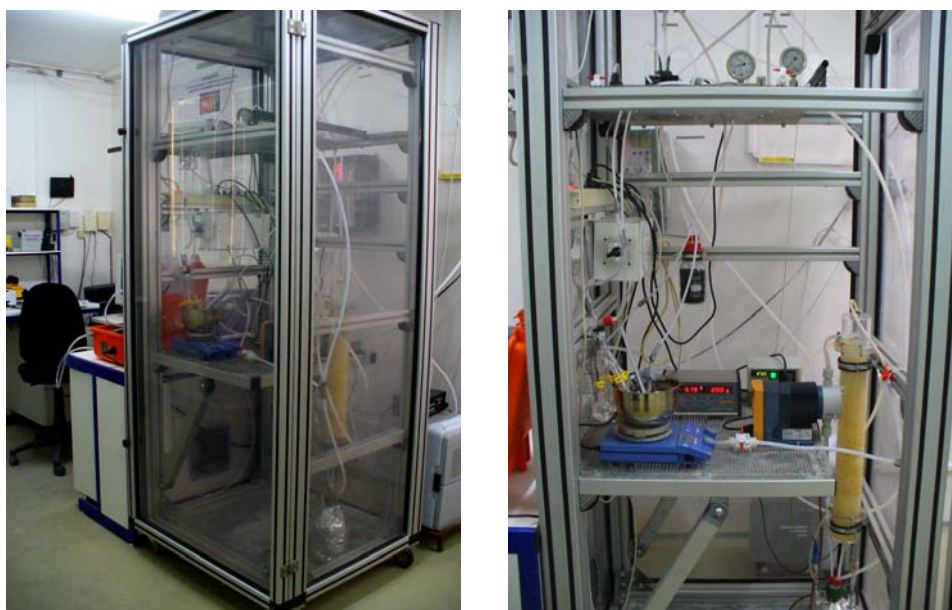
Obrázok 3.1 Pohľady na zariadenie biofiltra v laboratóriu bioplynovej stanice v Kolíňanoch
