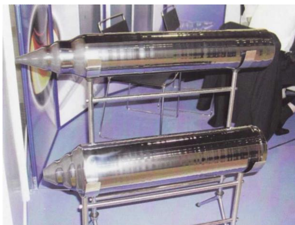
Obrázok 28 Kremikové ingoty - polotovary pre polovodičovú výrobu
