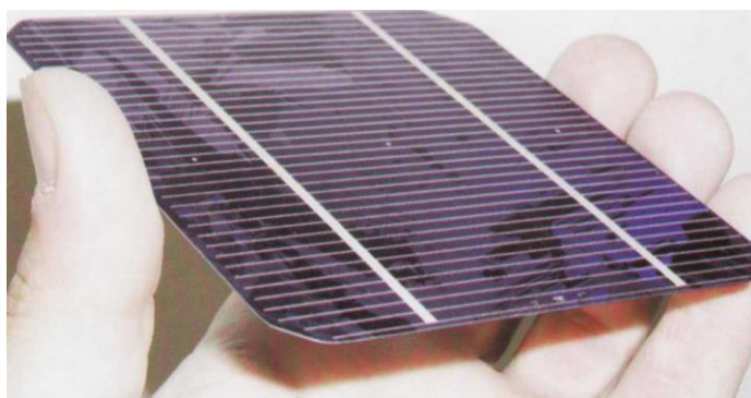
Obrázok 26 Polovodičový fotovoltaický článok na báze polykryštallického kremíka
