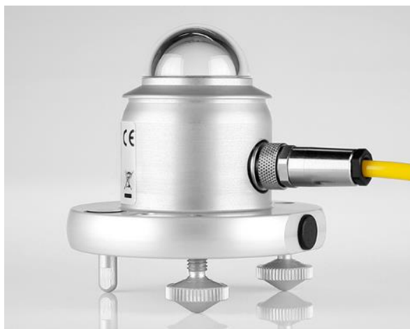
Obrázok 43 Pyranometer CMP3, Zdroj: (Kipp & Zonen, 2016)
