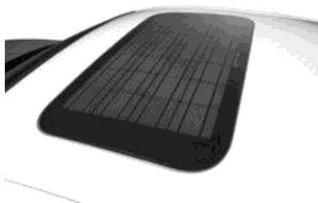
Obrázok 50 Solárny panel integrovaný do strešného okna, Zdroj: ( http://www.hybrid.cz/novinky/bethansolarni-auto-z-cambridge )
